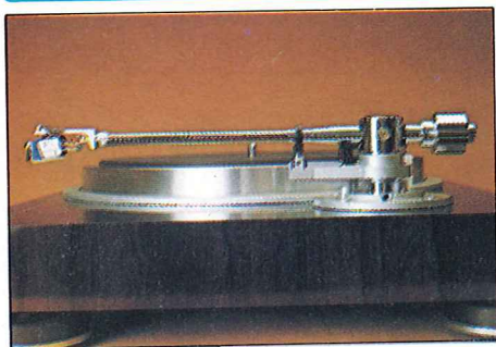
Il braccio impiegato nel KD 700D è dritto con massa efficace particolarmente bassa.
